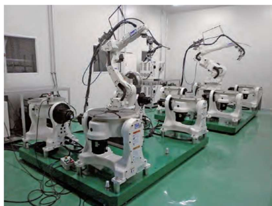
▲TIG 溶接ロボット+ポジショナー （ロボット 1 台につき各 4 台）
