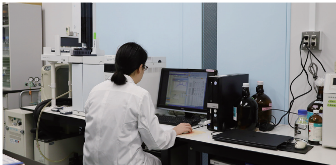
ガスクロマトグラフィーで36種の脂肪酸の分析が可能
